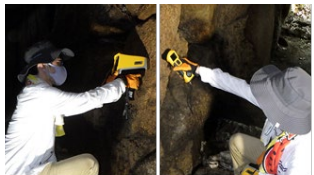
写真4 蛍光X線分析装置(左上)と帯磁率計(右上)による古墳石室の分析 石材の化学組成と磁性鉱物の含有量を非破壊的に測定することができる。
