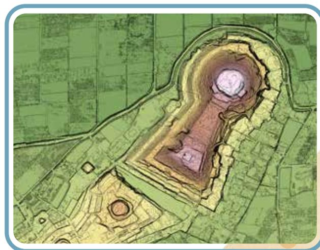
岡山大学の研究チームでは、2020年より岡山県内の古墳を対象に、ドローンを用いたレーザ測量を実施してきた。この方法は、古墳本体だけでなく、周辺地形も含めた広範囲を一度に測量できるという大きな利点がある。測量対象は、墳丘長約350mの全国第4位の巨大前方後円墳である岡山市造山古墳から、10数メートル程度の大きさの円墳・方墳まで大小さまざまである。本報告では、これまで測量を通じて作成した図面を示しながら、県下の豊かな古墳のすがたを描く。
